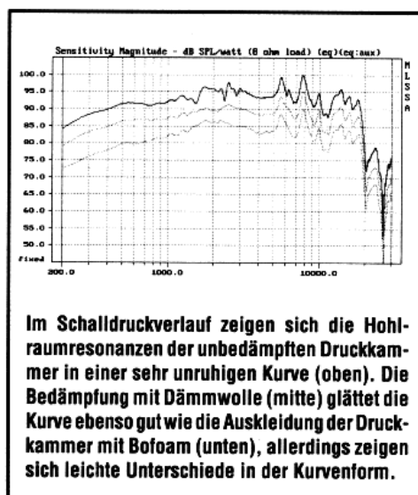
Die Nahfeldmessung vor dem Hornmund zeigt die maximale Wirkung der Konstruktion zwischen 60 und 700 Hertz. Bei unbedämpfter Druckkammer ist die Kurve sehr wellig, während die Bedämpfung mit Bof foam die Kurve glättet. Bei mit Dämmwolle gefüllter Druckkammer sinkt der Tieftonpegel um 5 dB.
